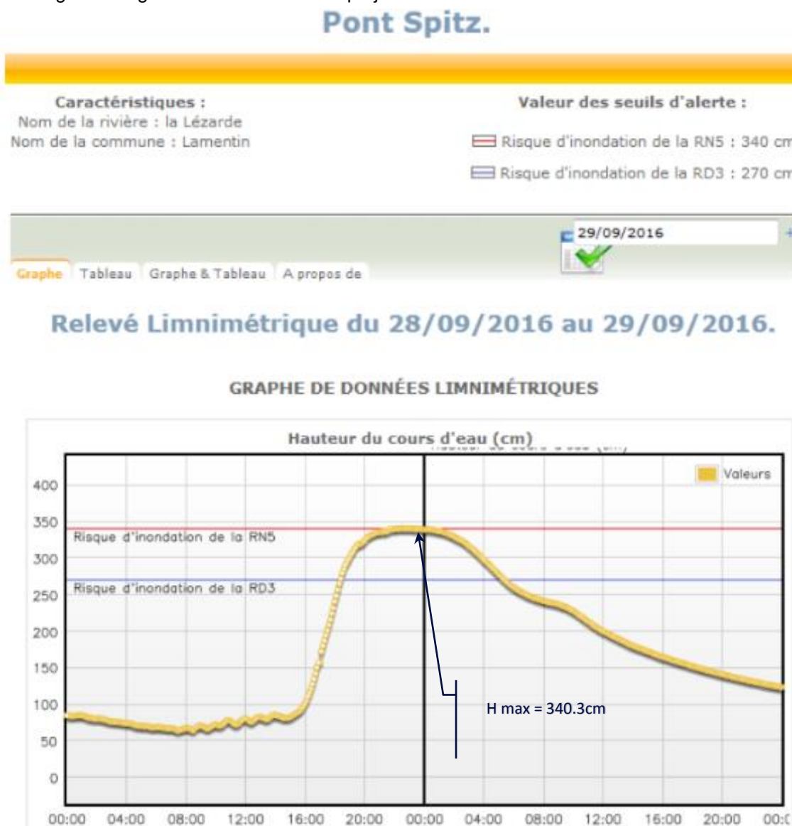
Figure 23 : Relevé limnimétrique de la station du Pont Spitz de l'évènement Matthew avec seuils d'inondabilité non actualisés
