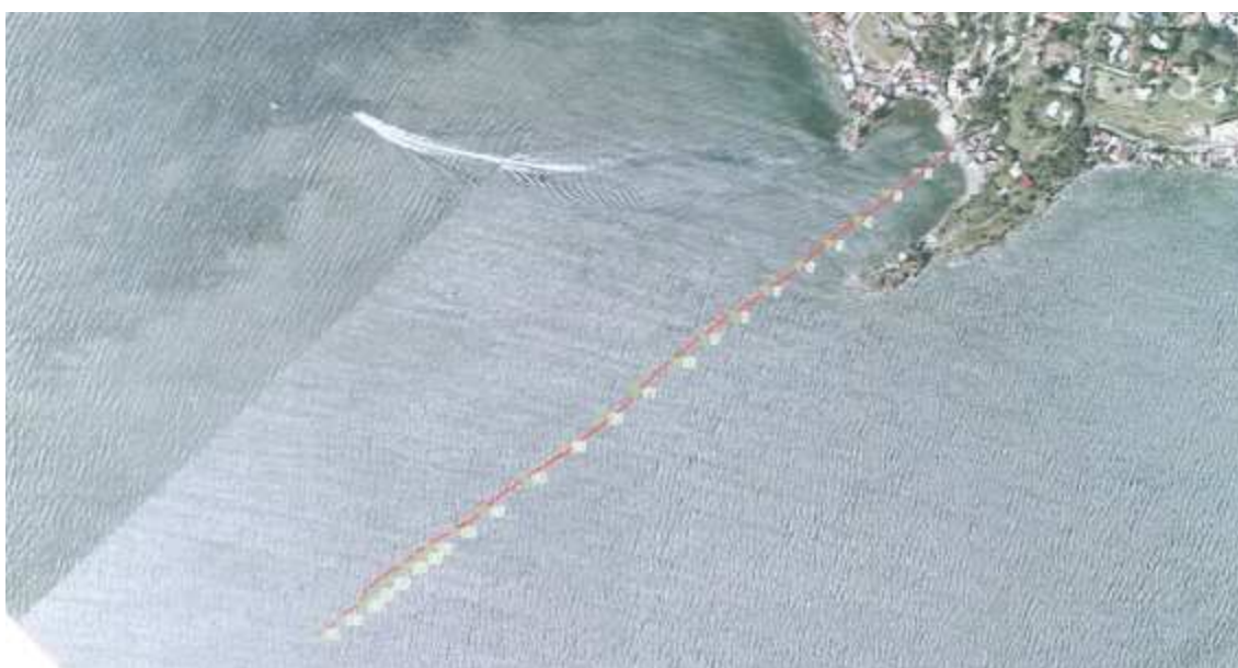
Figure 29. Emissaire de rejet des eaux en mer (Source : CREOCEAN)
