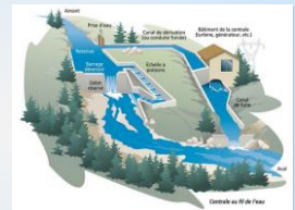
Fonctionnement d'une PCH en dérivation
